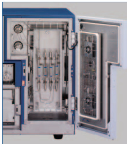
Abb. 2: Optimale Basislinienstabilität auch unter schlechten äußeren Bedingungen durch den Ofen im Ofen
